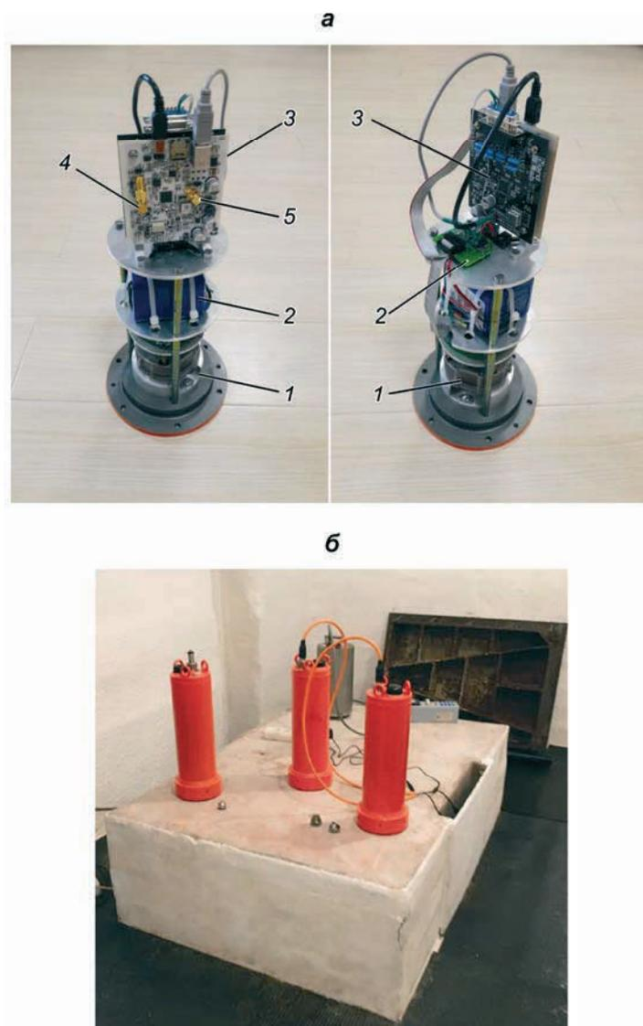
**Рис. 1.** Конструкция геогидроакустического модуля (а) и внешний вид размещения геогидроакустических буйев на постаменте в г. Обнинск 30.08.2017 г. (б): 1 – аналоговый молекулярно-электронный вертикальный сейсмический датчик; 2 – литий-ионная батарея с платой согласования; 3 – 24-разрядный регистратор сейсмических сигналов; 4 – разъем подключения внешней антенны Wi-fi; 5 – разъем подключения внешней антенны GPS
