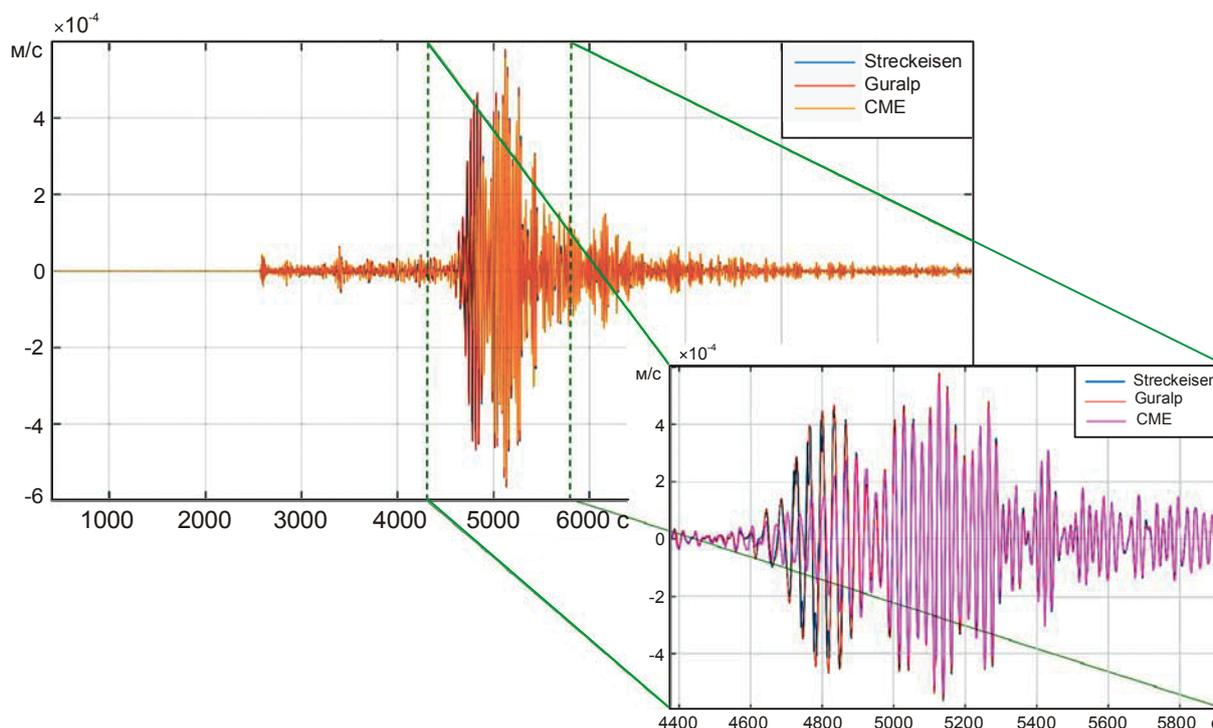
**Рис. 3.** Сопоставление записей, полученных приборами Streckeisen, Guralp и CME в частотном диапазоне 0.03–10 Гц, землетрясения магнитудой 8.1, произошедшего в Мексике 08.09.2017 г. в 04:49 по всемирному времени
